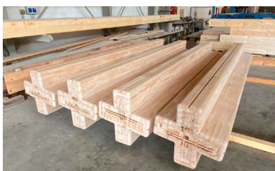
Foto. X-lam Dolomiti. Fabricación de pilares de castaño.
