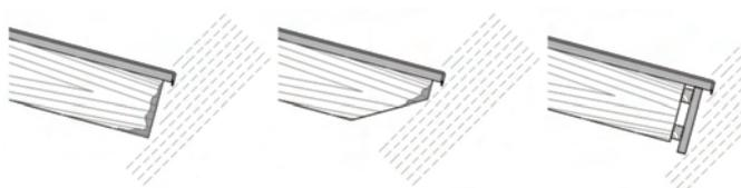
Figura 10. Protección de la cara superior y testa de una viga. En el ejemplo de la izquierda, el diseño puede provocar que la testa reciba un mayor volumen de agua pudiendo acelerar su degradación.
